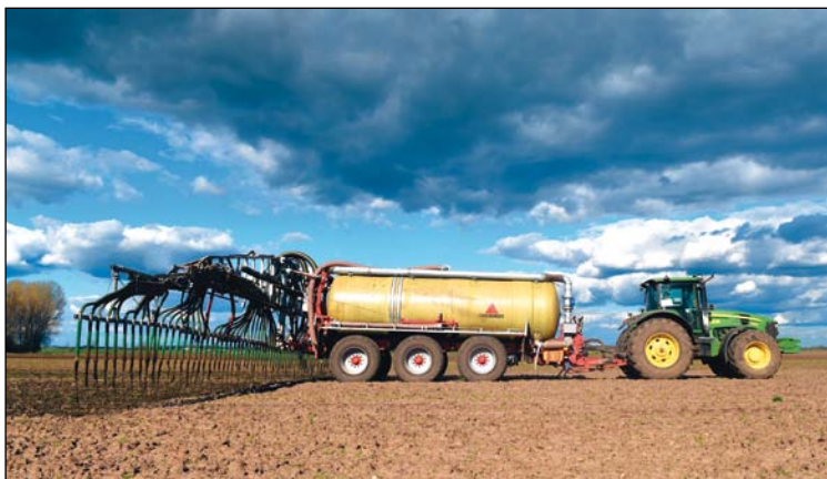
Ve městě Bertkow jezdí cisterna Annaburger o objemu 21 m 3 s hadicovým aplikátorem širokým 24 metrů
