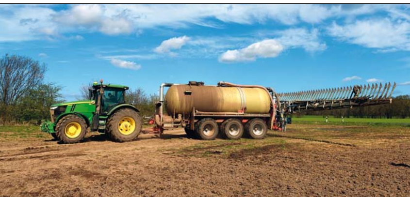
Cisterna HTS 33.28 o objemu 27 m 3 s traktorem John Deere o výkonu 230 koní
