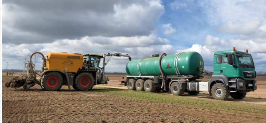
Přívozná sedlová cisterna Annaburger LS 38.28 o objemu 28,5 m 3 s flotačními pneumatikami za tahačem MAN
