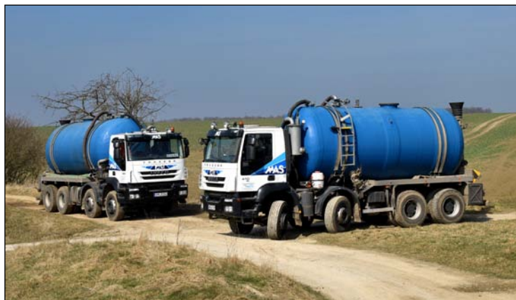
Nákladní automobily Iveco s cisternovými nástavbami Annaburger o objemu 19 m 3
