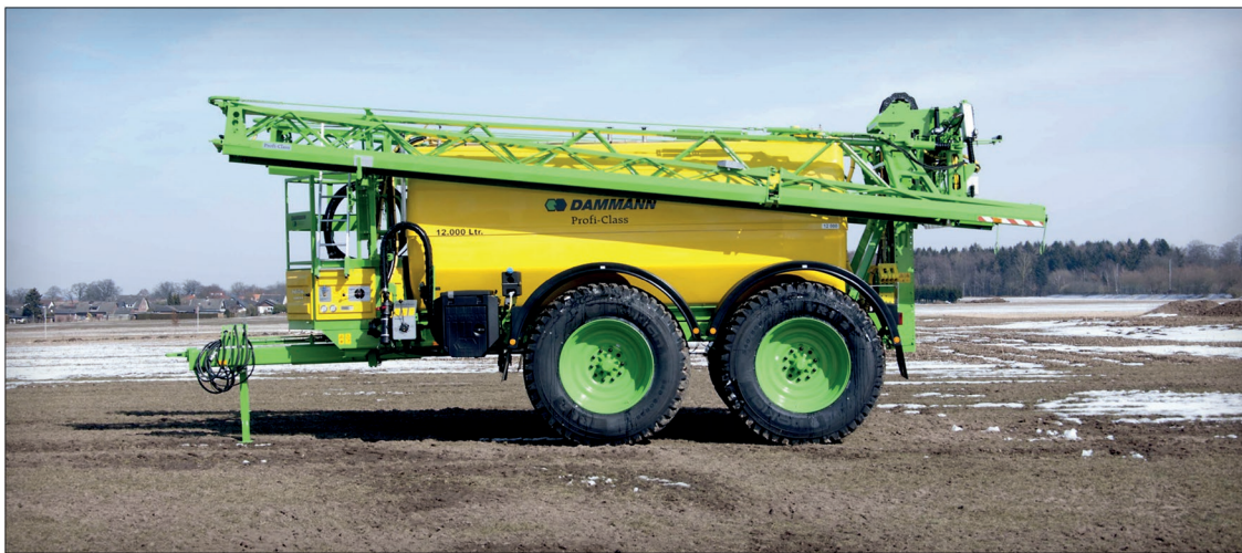
Postřikovače Profi Class mohou mít jednu až dvě nápravy a objem nádrže až 14 000 litrů
