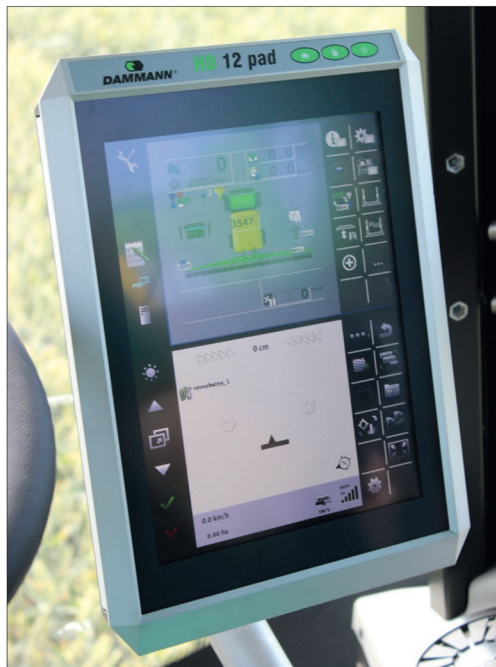
Při nastavení a kontrole postřikovače obsluha pomáhá počítač Müller Elektronik
