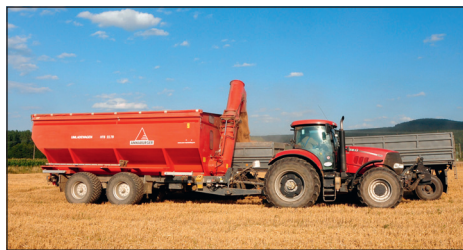
Překládací vůz HTS 22.16 Kloubová nebo hydraulicky odpružená náprava, objem 28 m 3 , překládací výkon 15 m 3 /min, výměnný systém nebo jednoúčelový stroj, pneumatiky s ráfkem až 30,5 palce
