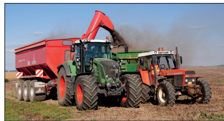
Překládací vůz HTS 29.16 a HTS 33.16 Parabolická nebo hydraulicky odpružená náprava, 1. a 3. náprava natáčecí, objem 33 a 36 m 3 , překládací výkon 15 m 3 /min, výměnný systém nebo jednoúčelový stroj, pneumatiky s ráfkem až 30,5 palce
