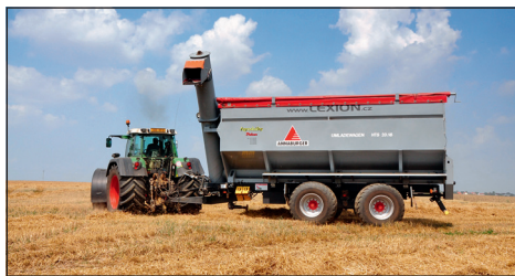
Překládací vůz HTS 20.16 Kloubová nebo hydraulicky odpružená náprava, objem 25 m 3 , překládací výkon 15 m 3 /min, výměnný systém nebo jednoúčelový stroj
