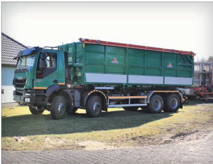
Dvoustranně sklápěná korba o objemu 32 m 3 jako výměnná nástavba na podvozku Iveco
