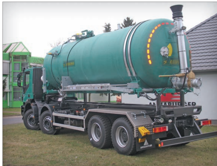
Cisternová nástavba jako součást výměnného systému na nákladní auto připravená k odstavení
