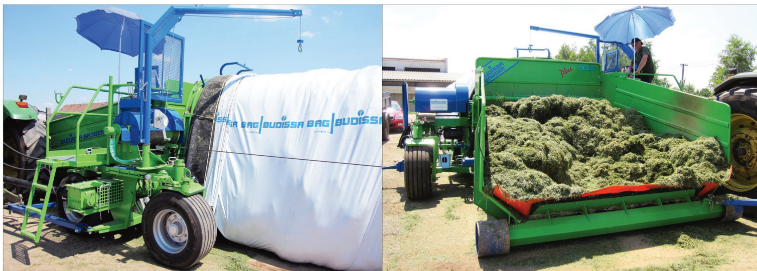
Nový typ lisu RT 8000 PLUS s komorou 3 m a s 90m lany
